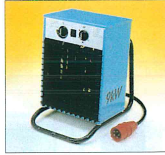
VF9, 9 kW Elektro-Heizlüfter 3~ 400 V, 50/60 Hz, IP 44. CEE-Stecker mit Anschlußkabel, serienmäßig. Stufenlos regelbarer Thermostat von ca. 5 -45°C. Leistungsschalter 4-stufig: Ventilatorbetrieb, halbe Heizleistung bei reduzierter Drehzahl, halbe Heizleistung bei voller Drehzahl, volle Heizleistung bei voller Drehzahl. Überhitzungsschutz. VF9T, jedoch mit 14-Stunden-Zeitschaltuhr.
