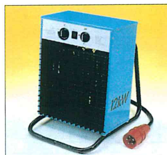
VF12, 12 kW Elektro-Heizlüfter 3~ 400 V, 50/60 Hz, IP 44. CEE-Stecker mit Anschlußkabel, serienmäßig. Stufenlos regelbarer Thermostat von ca. 5 -45°C. Leistungsschalter 3-stufig: Ventilatorbetrieb, halbe Leistung 6 kW, volle Leistung 12 kW. Überhitzungsschutz. VF12T, 12 kW Elektro-Heizlüfter: Ausführung wie VF12, jedoch mit 14-Stunden-Zeitschaltuhr.
