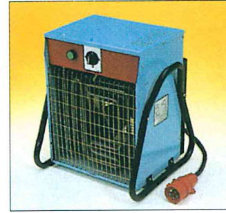
VFBR9 Sondermodell 9 kW Elektro-Heizlüfter 3~ 380 V, 50/60 Hz, IP 54. CEE-Stecker mit Anschlußkabel serienmäßig. Einsatz nur transportabel. Stufenlos regelbarer Thermostat von ca. 5 -45°C. Leistungsschalter 1-stufig: Ventilatorbetrieb bei voller Heizleistung. Überhitzungsschutz. Staubdichte Spezial-Ausführung.
