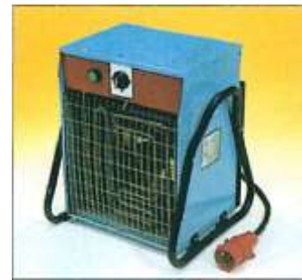
VFBR9 Sondermodell 9 kW Elektro-Heizlüfter 3- 380 V, 50/60 Hz, IP 54. CEE-Stecker mit Anschlußkabel serienmäßig. Einsatz nur transportabel. Stufenlos regelbarer Thermostat von ca. 5 -45°C. Leistungsschalter 1-stufig: Ventilatorbetrieb bei voller Heizleistung. Überhitzungsschutz. Staubdichte Spezial-Ausführung.
