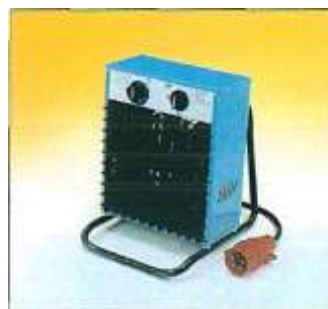
VF6, 6 kW Elektro-Heizlüfter 3-400 V, 50/60 Hz, IP 44. CEE-Stecker mit Anschlußkabel, serienmäßig. Stufenlos regelbarer Thermostat von ca. 5 -45°C. Leistungsschalter 3-stufig: Ventilatorbetrieb, halbe Leistung 3 kW, volle Leistung 6 kW. Überhitzungsschutz. VF6T, 6 kW Elektro-Heizlüfter: Ausführung wie VF6, jedoch mit 14-Stunden-Zeitschaltuhr.
