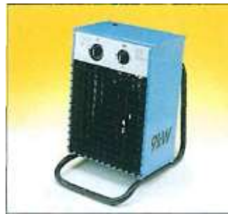
VF9B Sondermodell 9 kW Elektro-Heizlüfter 3- 400 V, 50/60 Hz, IP 44. CEE-Stecker am Gerät ohne Kabel. Einsatz nur transportabel. Stufenlos regelbarer Thermostat von ca. 5 -45°C. Leistungsschalter 1-stufig: Ventilatorbetrieb bei voller Heizleistung. Überhitzungsschutz. VF9BT, 9 kW Elektro-Heizlüfter: wie VF9B, jedoch mit 14-Stunden-Zeitschaltuhr.
