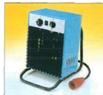
VF9, 9 kW Elektro-Heizlüfter 3-400 V, 50/60 Hz, IP 44. CEE-Stecker mit Anschlußkabel, serienmäßig. Stufenlos regelbarer Thermostat von ca. 5-45°C. Leistungsschalter 4-stufig: Ventilatorbetrieb, halbe Heizleistung bei reduzierter Drehzahl, halbe Heizleistung bei voller Drehzahl, volle Heizleistung bei voller Drehzahl. Überhitzungsschutz. VF9T, 9 kW Elektro-Heizlüfter: Ausführung wie VF9, jedoch mit 14-Stunden-Zeitschaltuhr.
