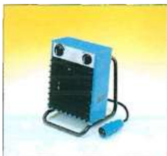
VF31, 3,3 kW Elektro-Heizlüfter - 230 V, 50/60 Hz, IP 44. CEE-Stecker mit Anschlußkabel, serienmäßig. Stufenlos regelbarer Thermostat von ca. 5 -45°C. Leistungsschalter 3-stufig: Ventilatorbetrieb, halbe Leistung 1,65 kW, volle Leistung 3,3 kW. Überhitzungsschutz. VF31T, 3,3 kW Elektro-Heizlüfter: Ausführung wie VF31, jedoch mit 14-Stunden-Zeitschaltuhr.
