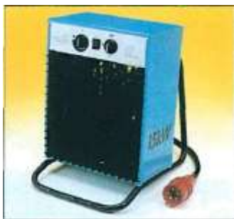
VF15, 15 kW Elektro-Heizlüfter 3-400 V, 50/60 Hz, IP 44. CEE-Stecker mit Anschlußkabel, serienmäßig. Stufenlos regelbaren Thermostat von ca. 5 -45°C. Leistungsschalter 3-stufig: Ventilatorbetrieb, halbe Leistung 7,5 kW, volle Leistung 15 kW. Überhitzungsschutz. VF15T, 15 kW Elektro-Heizlüfter: Ausführung wie VF15, jedoch mit 14-Stunden-Zeitschaltuhr.
