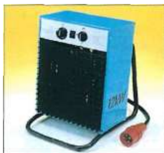
VF12, 12 kW Elektro-Heizlüfter 3- 400 V, 50/60 Hz, IP 44. CEE-Stecker mit Anschlußkabel, serienmäßig. Stufenlos regelbaren Thermostat von ca. 5 -45°C. Leistungsschalter 3-stufig: Ventilatorbetrieb, halbe Leistung 6 kW, volle Leistung 12 kW. Überhitzungsschutz. VF12T, 12 kW Elektro-Heizlüfter: Ausführung wie VF12, jedoch mit 14-Stunden-Zeitschaltuhr.
